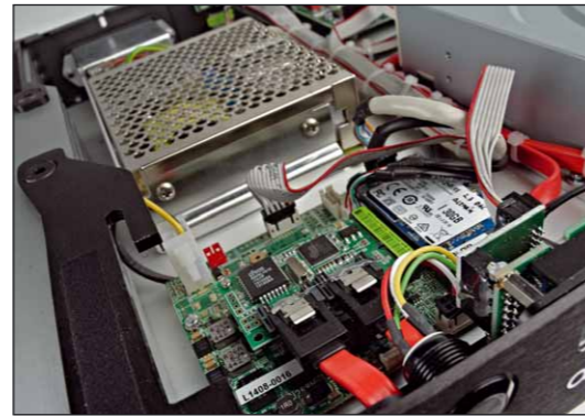
Der eigentliche Rechner ist klein gehalten und kommt komplett ohne aktive Kühlung aus
